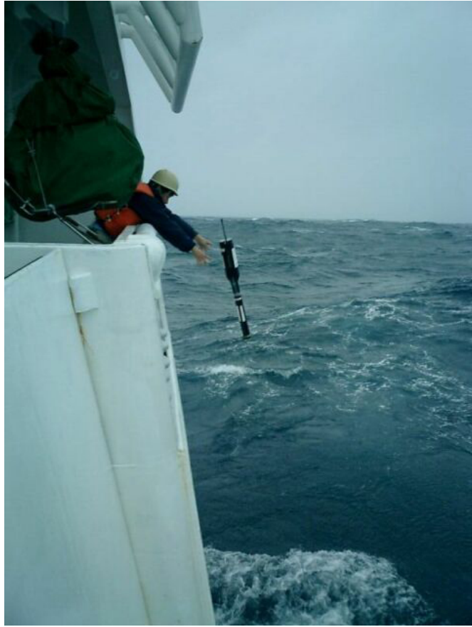
投棄式流速計XCPの投入
